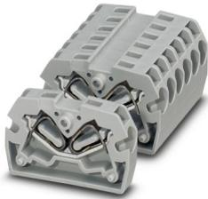
Minidurchgangsklemme, montierbar in Kombination mit D-MSBV 2,5-F und MSBV 2,5-F, Nennspannung: 800 V, Nennstrom: 24 A, Anzahl der Anschlüsse: 2, Anschlussart: Zugfederanschluss, Bemessungsquerschnitt: 2,5 mm<sup>2</sup>, 1. Etage, Querschnitt: 0,08 mm<sup>2</sup> - 4 mm<sup>2</sup>, Montageart: Direktmontage mit Flansch, Farbe: grau
