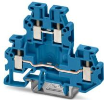
Minidurchgangsklemme, Nennspannung: 500 V, Nennstrom: 22 A, Anschlussart: Schraubanschluss, Bemessungsquerschnitt: 2,5 mm<sup>2</sup>, Querschnitt: 0,2 mm<sup>2</sup> - 4 mm<sup>2</sup>, Montageart: NS 15, NS 35/7,5, NS 35/15, Farbe: blau
