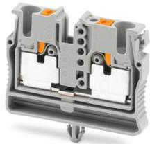
Minidurchgangsklemme, Nennspannung: 800 V, Nennstrom: 24 A, Anzahl der Anschlüsse: 2, Polzahl: 1, Anschlussart: Push-in-Anschluss, Bemessungsquerschnitt: 2,5 mm<sup>2</sup>, Querschnitt: 0,14 mm<sup>2</sup> - 4 mm<sup>2</sup>, Montageart: Rastzapfenmontage, Farbe: grau
