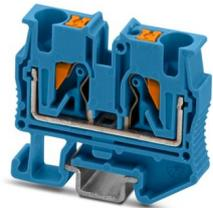
Minidurchgangsklemme, Nennspannung: 500 V, Nennstrom: 32 A, Polzahl: 1, Anschlussart: Push-in-Anschluss, Bemessungsquerschnitt: 4 mm<sup>2</sup>, Querschnitt: 0,2 mm<sup>2</sup> - 6 mm<sup>2</sup>, Montageart: NS 15, Farbe: blau
