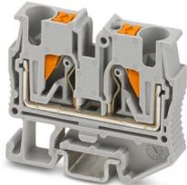
Minidurchgangsklemme, Nennspannung: 500 V, Nennstrom: 32 A, Polzahl: 1, Anschlussart: Push-in-Anschluss, Bemessungsquerschnitt: 4 mm<sup>2</sup>, Querschnitt: 0,2 mm<sup>2</sup> - 6 mm<sup>2</sup>, Montageart: NS 15, Farbe: grau
