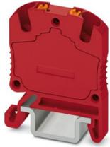
Microdurchgangsklemme, Nennspannung: 500 V, Nennstrom: 17,5 A, Anzahl der Anschlüsse: 2, Anschlussart: Push-in-Anschluss, Querschnitt: 0,14 mm<sup>2</sup> - 1,5 mm<sup>2</sup>, Montageart: NS 15, Farbe: rot
