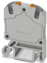
Microdurchgangsklemme, Nennspannung: 500 V, Nennstrom: 17,5 A, Anzahl der Anschlüsse: 2, Anschlussart: Push-in-Anschluss, Querschnitt: 0,14 mm<sup>2</sup> - 1,5 mm<sup>2</sup>, Montageart: NS 15, Farbe: grau
