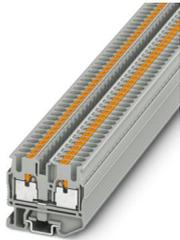
Minidurchgangsklemme, Nennspannung: 500 V, Nennstrom: 24 A, Anzahl der Anschlüsse: 2, Polzahl: 1, Anschlussart: Push-in-Anschluss, Bemessungsquerschnitt: 2,5 mm<sup>2</sup>, 1. Etage, Querschnitt: 0,14 mm<sup>2</sup> - 4 mm<sup>2</sup>, Montageart: NS 15, Farbe: grau
