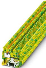
Mini-Schutzleiterklemme, Anzahl der Anschlüsse: 2, Anschlussart: Push-in-Anschluss, 1. Etage, Querschnitt: 0,14 mm<sup>2</sup> - 1,5 mm<sup>2</sup>, Montageart: NS 15, Farbe: grün-gelb
