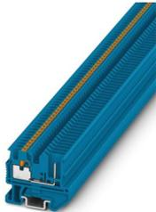
Minidurchgangsklemme, Nennspannung: 500 V, Nennstrom: 17,5 A, Anzahl der Anschlüsse: 2, Anschlussart: Push-in-Anschluss, Bemessungsquerschnitt: 1,5 mm<sup>2</sup>, 1. Etage, Querschnitt: 0,14 mm<sup>2</sup> - 1,5 mm<sup>2</sup>, Montageart: NS 15, Farbe: blau
