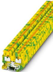
Mini-Schutzleiterklemme, Anzahl der Anschlüsse: 2, Anschlussart: Push-in-Anschluss, 1. Etage, Querschnitt: 0,14 mm<sup>2</sup> - 1,5 mm<sup>2</sup>, Montageart: NS 15, Farbe: grün-gelb
