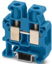
Minidurchgangsklemme, Nennspannung: 500 V, Nennstrom: 41 A, Anzahl der Anschlüsse: 2, Polzahl: 1, Anschlussart: Schraubanschluss, Bemessungsquerschnitt: 6 mm<sup>2</sup>, Querschnitt: 0,2 mm<sup>2</sup> - 10 mm<sup>2</sup>, Montageart: NS 15, Farbe: blau
