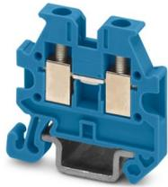
Minidurchgangsklemme, Nennspannung: 400 V, Nennstrom: 17,5 A, Anzahl der Anschlüsse: 2, Polzahl: 1, Anschlussart: Schraubanschluss, Bemessungsquerschnitt: 1,5 mm<sup>2</sup>, Querschnitt: 0,14 mm<sup>2</sup> - 1,5 mm<sup>2</sup>, Montageart: NS 15, Farbe: blau
