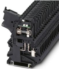
Sicherungsreihenklemme, Art der Sicherung: Glas / Keramik / ..., Sicherungstyp: G / 5 x 20, Nennspannung: 24 V, Nennstrom: 6,3 A, Anschlussart: Schraubanschluss, Bemessungsquerschnitt: 4 mm<sup>2</sup>, Querschnitt: 0,14 mm<sup>2</sup>- 6 mm<sup>2</sup>, Montageart: NS 35/7,5, NS 35/15, Farbe: schwarz
