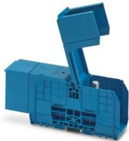
Bolzenanschlussklemme, Nennspannung: 1500 V, Nennstrom: 415 A, Anzahl der Anschlüsse: 2, Polzahl: 1, Anschlussart: Bolzenanschluss, Bemessungsquerschnitt: 240 mm<sup>2</sup>, Montageart: NS 35/7,5, NS 35/15, direktes Anschrauben, Farbe: blau
