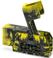
Bolzenanschlussklemme, Nennspannung: 1500 V, Nennstrom: 309 A, Anzahl der Anschlüsse: 2, Polzahl: 1, Anschlussart: Bolzenanschluss, Bemessungsquerschnitt: 150 mm<sup>2</sup>, 1. Etage, Montageart: NS 35/7,5, NS 35/15, direktes Anschrauben, Farbe: schwarz/gelb
