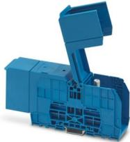
Bolzenanschlussklemme, Nennspannung: 1500 V, Nennstrom: 309 A, Anzahl der Anschlüsse: 2, Polzahl: 1, Anschlussart: Bolzenanschluss, Bemessungsquerschnitt: 150 mm<sup>2</sup>, 1. Etage, Montageart: NS 35/7,5, NS 35/15, direktes Anschrauben, Farbe: blau
