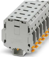
Hochstromklemme, Nennspannung: 1500 V, Nennstrom: 192 A, Anzahl der Anschlüsse: 2, Polzahl: 1, Anschlussart: Schraubanschluss, Bemessungsquerschnitt: 70 mm<sup>2</sup>, Querschnitt: 16 mm<sup>2</sup> - 95 mm<sup>2</sup>, Montageart: NS 35/7,5, NS 35/15, NS 35/15-2,3, NS 32, Farbe: grau
