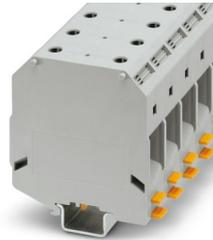
Hochstromklemme, Nennspannung: 1500 V, Nennstrom: 232 A, Anzahl der Anschlüsse: 2, Anschlussart: Schraubanschluss, Bemessungsquerschnitt: 95 mm<sup>2</sup>, Querschnitt: 25 mm<sup>2</sup> - 95 mm<sup>2</sup>, Montageart: NS 35/15, NS 32, Farbe: grau
