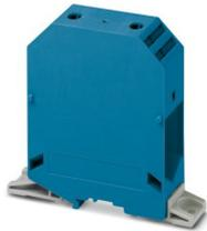
Hochstromklemme, Nennspannung: 1000 V, Nennstrom: 415 A, Anzahl der Anschlüsse: 2, Polzahl: 1, Anschlussart: Schraubanschluss, Bemessungsquerschnitt: 240 mm<sup>2</sup>, Querschnitt: 70 mm<sup>2</sup> - 240 mm<sup>2</sup>, Montageart: direktes Anschrauben, Farbe: blau
