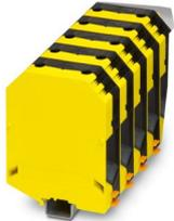
Hochstromklemme, Nennspannung: 1000 V, Nennstrom: 415 A, Anzahl der Anschlüsse: 2, Anschlussart: Schraubanschluss, Bemessungsquerschnitt: 240 mm<sup>2</sup>, Querschnitt: 70 mm<sup>2</sup> - 240 mm<sup>2</sup>, Montageart: NS 35/15, NS 32, Farbe: schwarz/gelb
