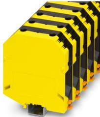
Hochstromklemme, Nennspannung: 1000 V, Nennstrom: 309 A, Anzahl der Anschlüsse: 2, Anschlussart: Schraubanschluss, Bemessungsquerschnitt: 150 mm<sup>2</sup>, Querschnitt: 35 mm<sup>2</sup> - 150 mm<sup>2</sup>, Montageart: NS 35/15, NS 32, Farbe: schwarz/gelb
