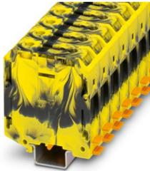
Hochstromklemme, Nennspannung: 1000 V, Nennstrom: 192 A, Anzahl der Anschlüsse: 2, Polzahl: 1, Anschlussart: Schraubanschluss, Bemessungsquerschnitt: 70 mm<sup>2</sup>, Querschnitt: 16 mm<sup>2</sup> - 70 mm<sup>2</sup>, Montageart: NS 35/7,5, NS 35/15, NS 35/15-2,3, NS 32, Farbe: schwarz/gelb
