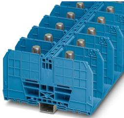
Bolzenanschlussklemme, Nennspannung: 1000 V, Nennstrom: 520 A, Anzahl der Anschlüsse: 2, Polzahl: 1, Anschlussart: Bolzenanschluss, Bemessungsquerschnitt: 300 mm<sup>2</sup>, Montageart: NS 35/7,5, NS 35/15, Farbe: blau
