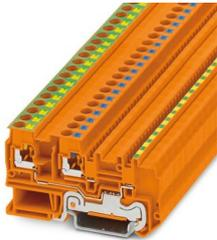
Initiatoren-/Aktorenklemme, Einspeiseklemme mit Schutzleiterfunktion, Nennspannung: 250 V, Nennstrom: 20 A, Anzahl der Anschlüsse: 2, Anschlussart: Push-in-Anschluss, Bemessungsquerschnitt: 2,5 mm<sup>2</sup>, Querschnitt: 0,2 mm<sup>2</sup> - 4 mm<sup>2</sup>, Montageart: NS 35/7,5, NS 35/15, Farbe: orange
