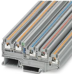
Initiatoren-/Aktorenklemme, mit grüner Leuchtanzeige, Nennspannung: 250 V, Nennstrom: 13,5 A, Anzahl der Anschlüsse: 5, Anschlussart: Push-in-Anschluss, Bemessungsquerschnitt: 1,5 mm<sup>2</sup>, Querschnitt: 0,14 mm<sup>2</sup> - 1,5 mm<sup>2</sup>, Montageart: NS 35/7,5, NS 35/15, Farbe: grau
