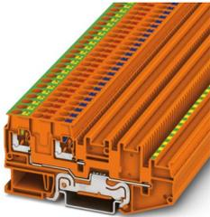
Initiatoren-/Aktorenklemme, Einspeiseklemme mit Schutzleiterfunktion, Nennspannung: 250 V, Nennstrom: 20 A, Anzahl der Anschlüsse: 3, Anschlussart: Push-in-Anschluss, Bemessungsquerschnitt: 2,5 mm<sup>2</sup>, Querschnitt: 0,2 mm<sup>2</sup> - 4 mm<sup>2</sup>, Montageart: NS 35/7,5, NS 35/15, Farbe: orange
