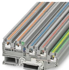
Initiatoren-/Aktorenklemme, mit grüner Leuchtanzeige und Schutzleiterfunktion, Nennspannung: 24 V, Nennstrom: 13,5 A, Anzahl der Anschlüsse: 5, Anschlussart: Push-in-Anschluss, Bemessungsquerschnitt: 1,5 mm<sup>2</sup>, Querschnitt: 0,14 mm<sup>2</sup> - 1,5 mm<sup>2</sup>, Montageart: NS 35/7,5, NS 35/15, Farbe: grau
