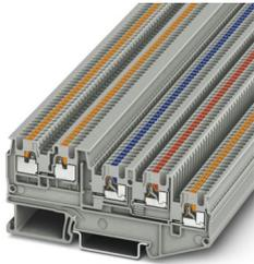
Initiatoren-/Aktorenklemme, Nennspannung: 250 V, Nennstrom: 13,5 A, Anzahl der Anschlüsse: 5, Anschlussart: Push-in-Anschluss, Bemessungsquerschnitt: 1,5 mm<sup>2</sup>, Querschnitt: 0,14 mm<sup>2</sup> - 1,5 mm<sup>2</sup>, Montageart: NS 35/7,5, NS 35/15, Farbe: grau
