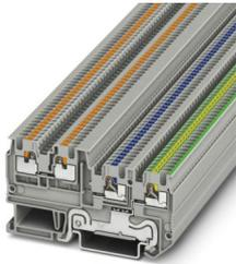
Initiatoren-/Aktorenklemme, mit Schutzleiterfunktion, Nennspannung: 250 V, Nennstrom: 13,5 A, Anzahl der Anschlüsse: 4, Anschlussart: Push-in-Anschluss, Bemessungsquerschnitt: 1,5 mm<sup>2</sup>, Querschnitt: 0,14 mm<sup>2</sup> - 1,5 mm<sup>2</sup>, Montageart: NS 35/7,5, NS 35/15, Farbe: grau
