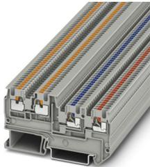
Initiatoren-/Aktorenklemme, Nennspannung: 250 V, Nennstrom: 13,5 A, Anzahl der Anschlüsse: 4, Anschlussart: Push-in-Anschluss, Bemessungsquerschnitt: 1,5 mm<sup>2</sup>, Querschnitt: 0,14 mm<sup>2</sup> - 1,5 mm<sup>2</sup>, Montageart: NS 35/7,5, NS 35/15, Farbe: grau
