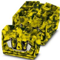
Minidurchgangsklemme, Nennspannung: 800 V, Nennstrom: 24 A, Anzahl der Anschlüsse: 4, Anschlussart: Zugfederanschluss, Bemessungsquerschnitt: 2,5 mm<sup>2</sup>, 1. Etage, Querschnitt: 0,08 mm<sup>2</sup> - 4 mm<sup>2</sup>, Montageart: Direktmontage mit Flansch, Farbe: schwarz/gelb
