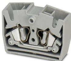
Minidurchgangsklemme, Nennspannung: 800 V, Nennstrom: 24 A, Anzahl der Anschlüsse: 4, Anschlussart: Zugfederanschluss, Bemessungsquerschnitt: 2,5 mm<sup>2</sup>, 1. Etage, Querschnitt: 0,08 mm<sup>2</sup> - 4 mm<sup>2</sup>, Montageart: auf Montageplatte, Farbe: grau
