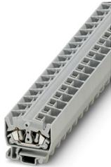
Minidurchgangsklemme, Nennspannung: 800 V, Nennstrom: 24 A, Anzahl der Anschlüsse: 4, Anschlussart: Zugfederanschluss, Bemessungsquerschnitt: 2,5 mm<sup>2</sup>, 1. Etage, Querschnitt: 0,08 mm<sup>2</sup> - 4 mm<sup>2</sup>, Montageart: NS 15, Farbe: grau
