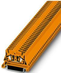
Minidurchgangsklemme, Nennspannung: 800 V, Nennstrom: 24 A, Anzahl der Anschlüsse: 2, Anschlussart: Zugfederanschluss, Bemessungsquerschnitt: 2,5 mm<sup>2</sup>, 1. Etage, Querschnitt: 0,08 mm<sup>2</sup> - 4 mm<sup>2</sup>, Montageart: NS 35/7,5, NS 35/15, Farbe: orange
