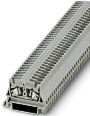
Minidurchgangsklemme, Nennspannung: 800 V, Nennstrom: 24 A, Anzahl der Anschlüsse: 2, Anschlussart: Zugfederanschluss, Bemessungsquerschnitt: 2,5 mm<sup>2</sup>, 1. Etage, Querschnitt: 0,08 mm<sup>2</sup> - 4 mm<sup>2</sup>, Montageart: NS 35/7,5, NS 35/15, Farbe: grau
