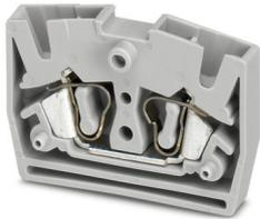
Minidurchgangsklemme, Nennspannung: 800 V, Nennstrom: 24 A, Anzahl der Anschlüsse: 2, Anschlussart: Zugfederanschluss, Bemessungsquerschnitt: 2,5 mm<sup>2</sup>, 1. Etage, Querschnitt: 0,08 mm<sup>2</sup> - 4 mm<sup>2</sup>, Montageart: auf Montageplatte, Farbe: grau
