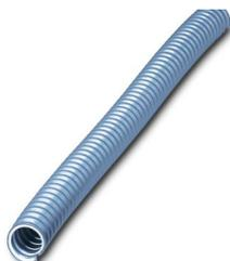
Schutzschlauch, Material: PU, Wendel: PUR ummantelter Federstahl, UV-beständig: nein, flexibel, Schutzart: IP68, Farbe: blau, Brennbarkeitsklasse nach UL 94: V2, Innendurchmesser: 16 mm, Gesamtlänge: 10 m
