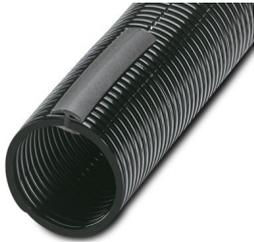
Schutzschlauch, Material: PA, UV-beständig: ja, flexibel, Schutzart: IP40, Farbe: schwarz, Brennbarkeitsklasse nach UL 94: HB, Innendurchmesser: 36 mm, Gesamtlänge: 10 m
