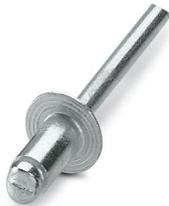
Blindniete, Ø 4,0 mm, Hülsenlänge 8 mm, Aluminium-Hülse, Stahldorn verzinkt, Flachkopf, Standardvariante ähnlich DIN 7337 A
