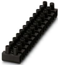
Europaklemmenleiste aus Polypropylen, schwarz, zum Verbinden von starren Leitern und flexiblen Leitern mit und ohne Aderendhülse mit einem Querschnitt von 1,5 bis 16 mm<sup>2</sup>
