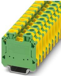
Schutzleiter-Reihenklemme, mit Schraubfuß, Anzahl der Anschlüsse: 2, Anschlussart: Schraubanschluss, Bemessungsquerschnitt: 16 mm<sup>2</sup>, Querschnitt: 1,5 mm<sup>2</sup> - 25 mm<sup>2</sup>, Befestigungsart: PE-Fuß mit Befestigungsschraube, M4, Montageart: NS 35/7,5, NS 35/15, Farbe: grün-gelb
