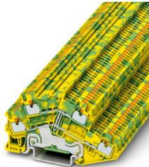
Schutzleiter-Doppelstockklemme, Anschlussart: Push-in-Anschluss, 1. und 2. Etage, Querschnitt: 0,14 mm<sup>2</sup> - 1,5 mm<sup>2</sup>, Montageart: NS 35/7,5, NS 35/15, Farbe: grün-gelb
