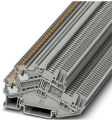
Doppelstockklemme, Strom und Spannung werden durch den eingesetzten Stecker bestimmt., mit Potenzialverbinder, Nennspannung: 500 V, Nennstrom: 16 A, Anschlussart: Push-in- / Steckanschluss, 1. und 2. Etage, Bemessungsquerschnitt: 1,5 mm<sup>2</sup>, Querschnitt: 0,14 mm<sup>2</sup> - 1,5 mm<sup>2</sup>, Montageart: NS 35/7,5, NS 35/15, Farbe: grau
