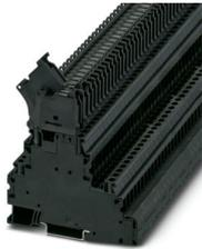
Sicherungsreihenklemme, Art der Sicherung: Glas / Keramik / ..., Sicherungstyp: G / 5 x 20, Nennspannung: 250 V, Thermischer Dauerstrom  $I_{th}$ : 28 A, Anschlussart: Schraubanschluss, Bemessungsquerschnitt: 4 mm<sup>2</sup>, Querschnitt: 0,14 mm<sup>2</sup>- 6 mm<sup>2</sup>, Anschlussart: Schraubanschluss, Bemessungsquerschnitt: 4 mm<sup>2</sup>, Querschnitt: 0,14 mm<sup>2</sup>- 6 mm<sup>2</sup>, Montageart: NS 35/7,5, NS 35/15, Farbe: schwarz
