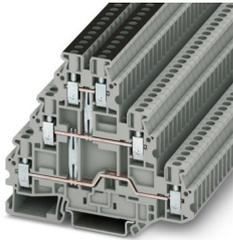
Mehrstockklemme, mit Potenzialverbinder, Nennspannung: 500 V, Nennstrom: 19 A, Anschlussart: Schraubanschluss, Bemessungsquerschnitt: 2,5 mm<sup>2</sup>, Querschnitt: 0,14 mm<sup>2</sup> - 4 mm<sup>2</sup>, Montageart: NS 35/7,5, NS 35/15, Farbe: grau
