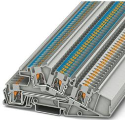
Installationsetagenklemme, Nennspannung: 400 V, Nennstrom: 28 A, Push-in-Anschluss, 1., 2. und 3. Etage, Bemessungsquerschnitt: 4 mm<sup>2</sup>, Querschnitt: 0,2 mm<sup>2</sup> - 6 mm<sup>2</sup>, Push-in-Anschluss, Montageart: NS 35/7,5, NS 35/15, Farbe: grau
