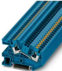
Installationsklemme, Nennspannung: 800 V, Nennstrom: 32 A, Push-in-Anschluss, 1. Etage, Bemessungsquerschnitt: 4 mm<sup>2</sup>, Querschnitt: 0,2 mm<sup>2</sup> - 6 mm<sup>2</sup>, Montageart: NS 35/7,5, NS 35/15, Farbe: blau
