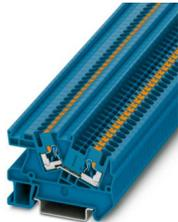
Installationsklemme, Nennspannung: 800 V, Nennstrom: 24 A, Push-in-Anschluss, 1. Etage, Bemessungsquerschnitt: 2,5 mm<sup>2</sup>, Querschnitt: 0,14 mm<sup>2</sup> - 4 mm<sup>2</sup>, Montageart: NS 35/7,5, NS 35/15, Farbe: blau
