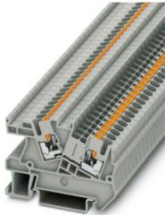
Installationsklemme, Nennspannung: 800 V, Nennstrom: 24 A, Push-in-Anschluss, 1. Etage, Bemessungsquerschnitt: 2,5 mm<sup>2</sup>, Querschnitt: 0,14 mm<sup>2</sup> - 4 mm<sup>2</sup>, Montageart: NS 35/7,5, NS 35/15, Farbe: grau
